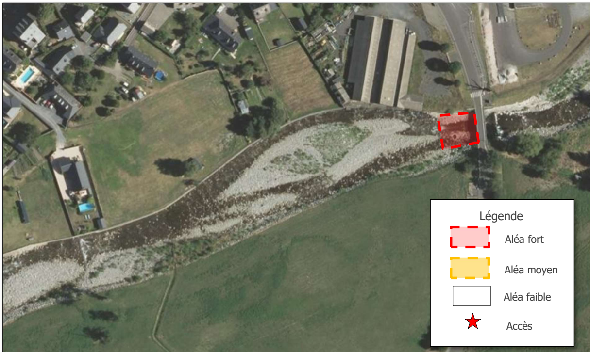
Figure 25 : Zone sensible à l'embâclage n° 2 en amont du pont interzones
